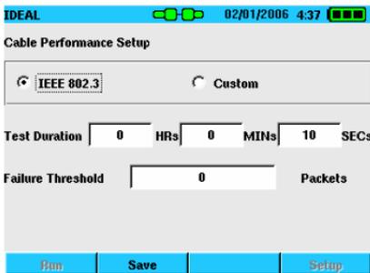
Standardmäßig ist IEEE 802.3 aktiviert. Wenn Sie andere Werte verwenden möchten, wählen Sie *Angepasst* aus und bestätigen mit Enter. Anschließend geben Sie die gewünschten Werte für die Testdauer und den Fehlerschwellwert ein. Maximal möglich sind 23 Stunden, 59 Minuten und 59 Sekunden. Mit F2 speichern Sie die Einstellungen.
