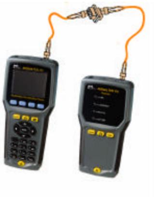
2. Drücken Sie in der Registerkarte *Autotest* oder *Manuell* die Schaltfläche *Kalibrieren*. Jetzt ermitteln die beiden Handgeräte die vom jeweils anderen Handgerät ausgesendeten Pegel und zeigen zum Abschluss die Ergebnisse an. Durch Drücken der ENTER-Taste löschen Sie die Meldung zum erfolgreichen Abschluss der Kalibrierung.
