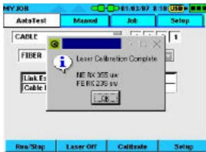
3. Zur Anzeige der Messergebnisse führen Sie einen Autotest aus oder wählen in der Registerkarte *Manuell* den Link-Aufbau-Test.
